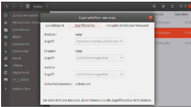
Zugriffsrechte im Dateimanager: Über Nautilus ermitteln Sie, was Sie in welchem Ordner dürfen. Unter Ubuntu können Sie auch auf Dateien in fremden Home-Verzeichnissen zugreifen.
