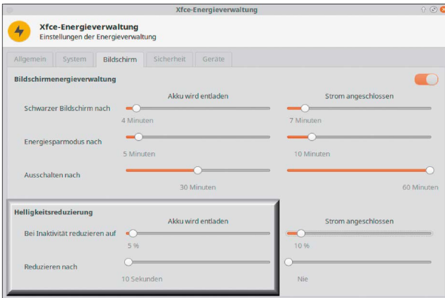
Displayverdunkelung nach kurzer Inaktivität: Diese Maßnahme ist neben der „Bereitschaft“ die wirksamste Stromsparoption. Beachten Sie auch analoge „Öko“-Einstellungsoptionen bei PC-Monitoren und Smart-TVs.
