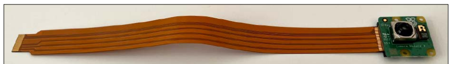
Die Kamera für den Raspberry Pi benötigt ein neues FPC-kompatibles Anschlusskabel.
