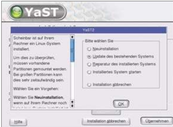
Neuinstallation oder Update: Findet Yast eine ältere Suse-Version, bietet es ein Update an. Vorherige Einstellungen bleiben erhalten (Punkt 3)
