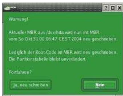
MBR restaurieren: Suse Linux sichert den MBR und kann so die Startumgebung wiederherstellen
