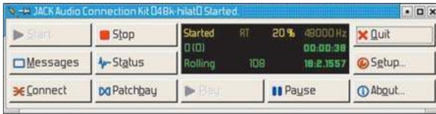
Die grafische Benutzeroberfläche qjackctl: Die jackd-Steuerzentrale zeigt, ob der Soundserver läuft, und liefert weitere Informationen, unter anderem über Sample-Rate, Timecode und CPU-Nutzung (Punkt 3)
