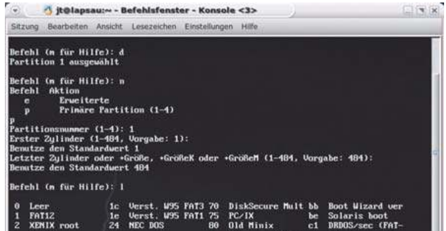
Externe Festplatte einrichten: Mit dem Konsolenprogramm fdisk erstellen Sie eine neue, Linux-kompatible Partition, auf der Sie später ein Linux-Dateisystem unterbringen können (Punkt 2)
