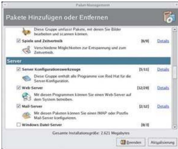
Apache-Installation unter Fedora Core: Im grafischen Software-Installer finden Sie zu diesem Zweck den Eintrag „Server, Web-Server“ (Punkt 2)
