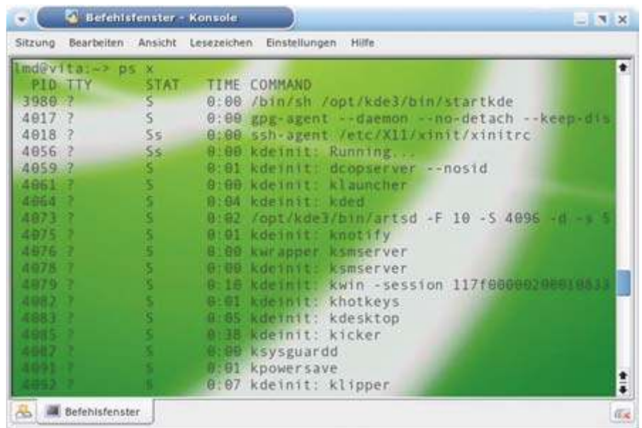
Systemprozesse unter Kontrolle: Wenn Sie den Befehl „ps x“ in ein Konsolenfenster eingeben, sehen Sie eine Liste aller Prozesse, die Sie bisher gestartet haben (Punkt 10)
