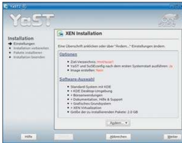
Gastsystem: Mit Hilfe des Yast-Moduls „Xen Installation“ kopieren Sie die Dateien in das gemountete Image (Punkt 4)
