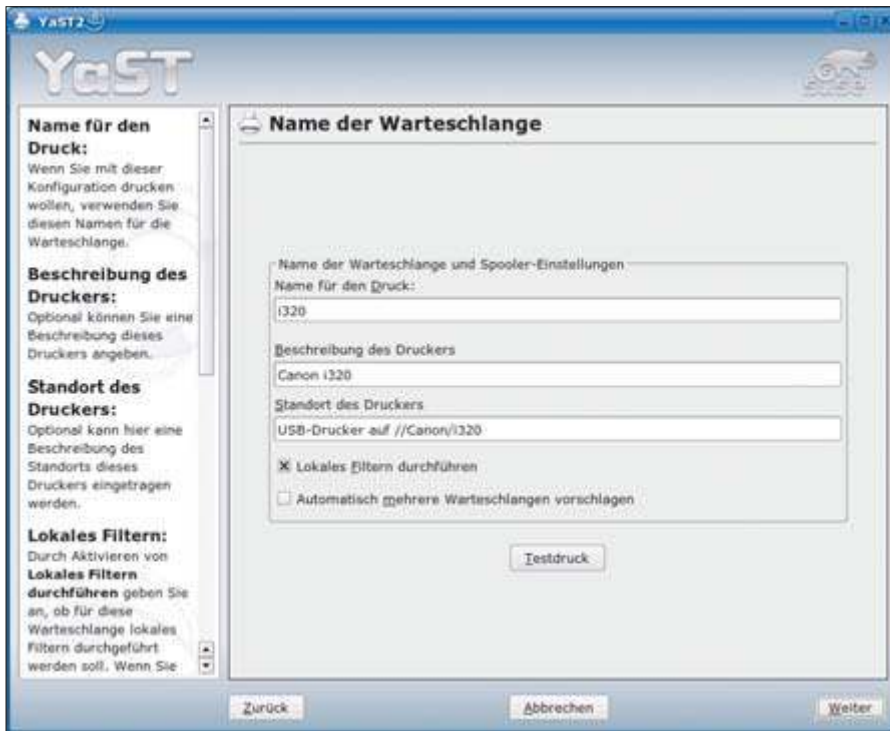
Drucker einrichten mit Yast: Für eine Vielzahl von Druckermodellen sind bereits PPD-Dateien mit dabei. Eigene Dateien können Sie ebenfalls hinzufügen (Punkt 7)
