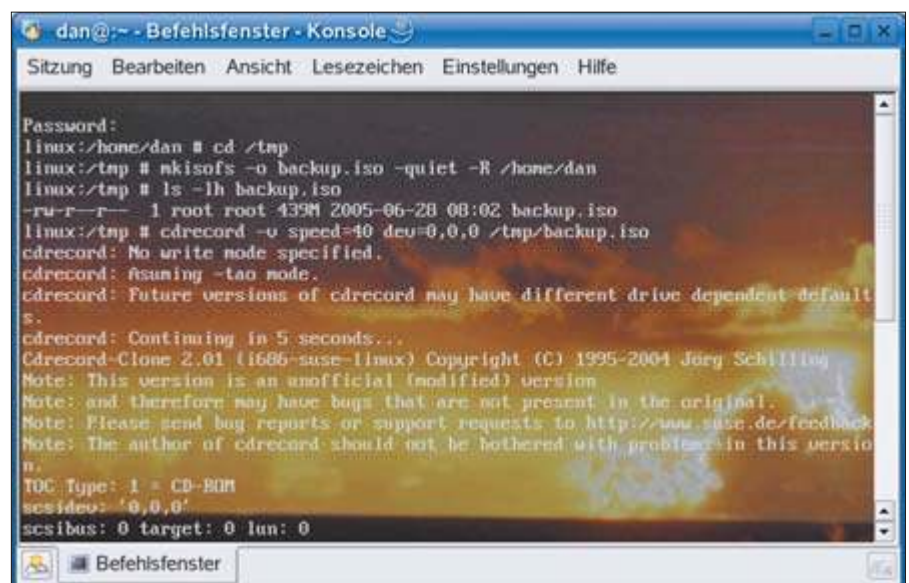
Datensicherung mit cdrecord: Für das Brennen einer CD oder DVD brauchen Sie keine grafische Oberfläche. Das Konsolenprogramm bietet zahlreiche Optionen (Punkt 1)
