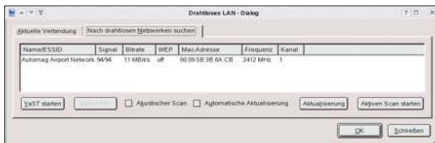
Profilwechsel mit KInternet: Haben Sie die Verbindung zuvor mit Yast konfiguriert, können Sie sich per Mausklick mit einem erreichbaren WLAN-Netzwerk verbinden (Punkt 2)
