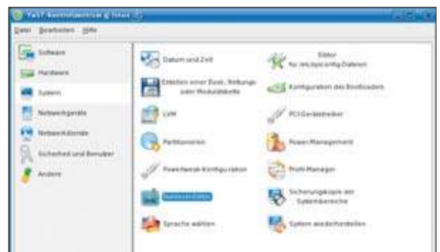
Runlevel-Editor: Auch mit Yast lässt sich festlegen, welche Services automatisch starten sollen (Punkt 1)
