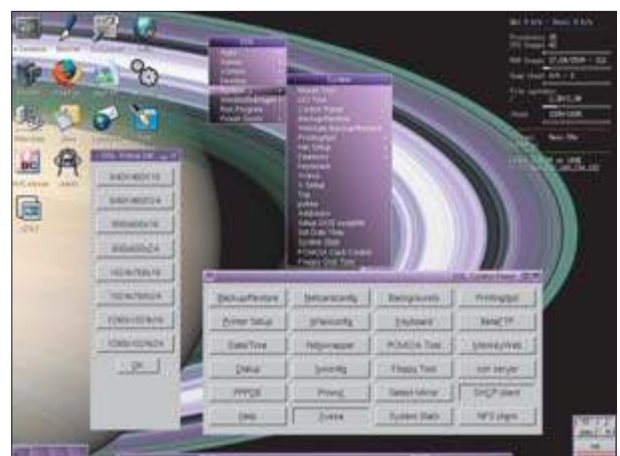
Schaltzentrale: Im DSL-Panel konfigurieren Sie Netzwerkzugang, Drucker und Bildschirmauflösung (Punkt 5)
