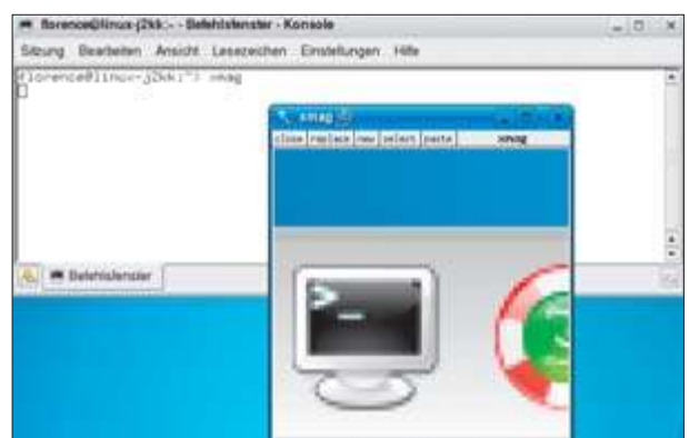
Vergrößern per Mausklick: Über den Befehl „xmag“ lassen sich Bildschirmausschnitte vergrößern (Punkt 2)
