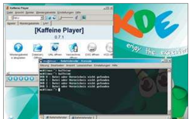
Fehlgeschlagene DVB-T-Installation: Kaffeine liefert auf der Konsole den entsprechenden Hinweis (Punkt 5)
