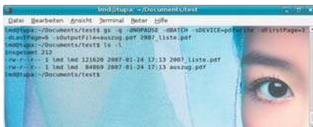
PDF-Dateien gekonnt zerlegen: ghostscript extrahiert die gewünschten Seiten aus dem angegebenen Dokument (Punkt 2)
