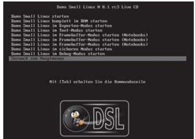
Untermenüs: Jede Distribution besitzt ein eigenes Menü, das spezifische Startoptionen zur Verfügung stellt (Punkt 1)
