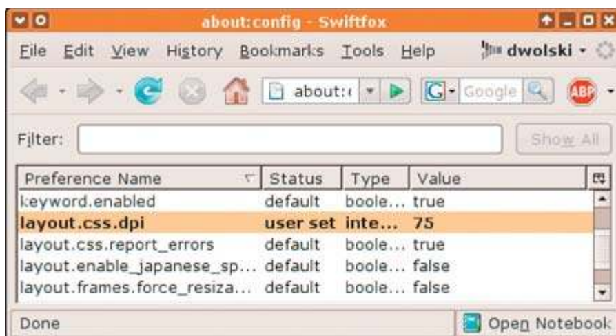
Schriftgrößen: Firefox/Iceweasel hat eigene Einstellungen für seine Bedienoberfläche, die Einstellungen des Desktops interessieren den Browser nicht (Punkt 7)
