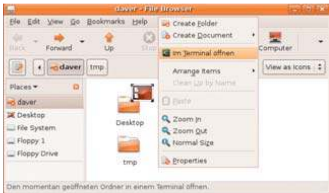
Menüpunkt nachgerüstet: Mit dem Paket „nautilus-open-terminal“ lässt sich das Terminal von überall aus öffnen (Punkt 4)
