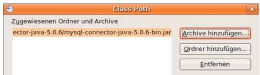
JDBC-Treiber einbinden: Das aus dem Treiberverzeichnis zugewiesene Archiv verknüpfen Sie über „Archive hinzufügen“ mit Open Office (Punkt 4)
