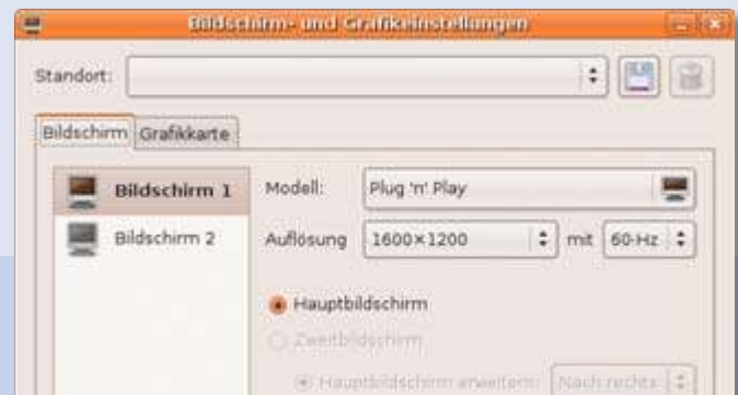
Bildschirmauflösung, Dual-Monitor-Betrieb und mehr: Mit dem neuen Einrichtung dialog erledigen Sie diese Konfigurationsschritte bequem auf der grafischen Oberfläche (Punkt 3)
