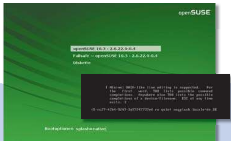
Kernel-Start beobachten: Die Kernel-Meldungen werden meist hinter Splashscreens versteckt. Mit diesen Optionen machen Sie sie unter Suse (hinten) und Ubuntu (vorne) sichtbar (Punkt 4)
