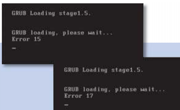
Defekter Bootmanager: Wenn Grub nicht startet, sind häufig fehlende Konfigurationsdateien die Ursache (Punkt 1 und 3)
