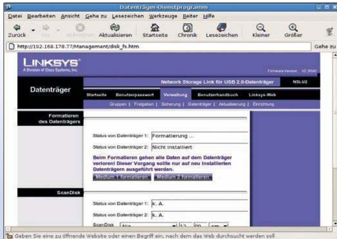
Vorarbeit: Bevor Sie Unslung als Firmware nutzen können, müssen Sie vorab das Root-Device über die Linksys-Oberfläche formatieren
