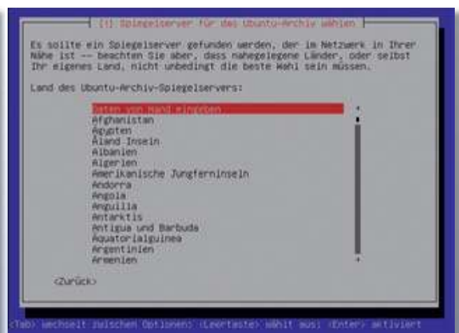
Software per Apache: Die Installationsdateien zieht sich der Installer über das Netz, Sie müssen die Quelle aber selbst konfigurieren
