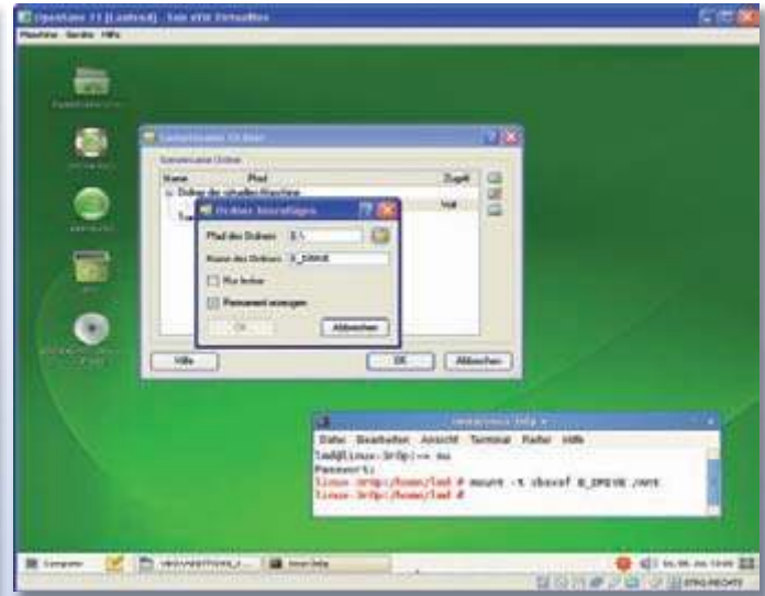
Gemeinsame Ordner einrichten: Erst fügen Sie den gewünschten Ordner des Hosts hinzu (oberer Teil), dann binden Sie ihn in das Gastsystem ein (Konsolenfenster)
