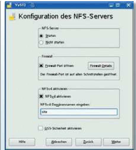
NFS-Server konfigurieren: Nach dem Nachrüsten des Server-Moduls sorgen Sie zunächst für die Aktivierung und einen offenen Firewall-Port
