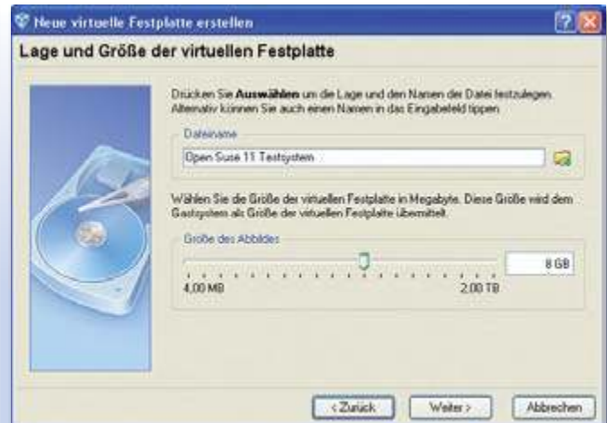
Virtuelle Festplatte anlegen: Seien Sie nicht zu sparsam mit dem Plattenplatz, Sie können die virtuelle Festplatte später nicht vergrößern – allerdings können Sie weitere Festplatten ergänzen
