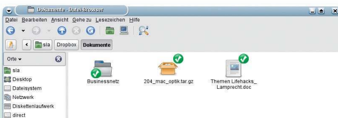
Dropbox-Ordner im Home-Verzeichnis: Der Dateimanager Nautilus informiert mit kleinen Icons über den Status der gesicherten Dateien. Ein grünes Häkchen heißt: Die Dateien sind bereits mit dem Server synchronisiert
