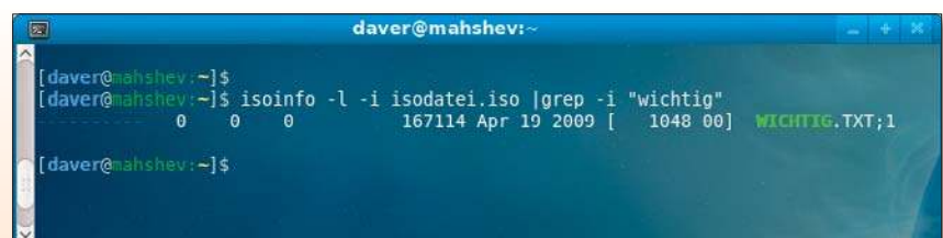
Inhaltsverzeichnis: Wer schnell einen Blick in eine ISO-Datei werfen möchte, dem hilft das Kommandozeilen-Tool isoinfo, das den Inhalt eines ISO9660-Images als Dateiliste ausgibt
