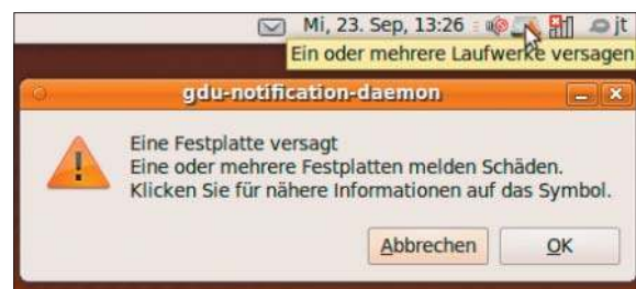
Gesundheit: Anhand der Smart-Daten in der Festplatten-Firmware erkennt Palimpsest schwerwiegende Defekte und warnt
