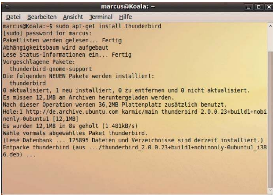
Flott auf der Konsole installieren: Mit „apt-get“ installieren Sie in einem Terminal-Fenster schnell Software-Pakete – hier beispielsweise den Mail-Client Thunderbird
