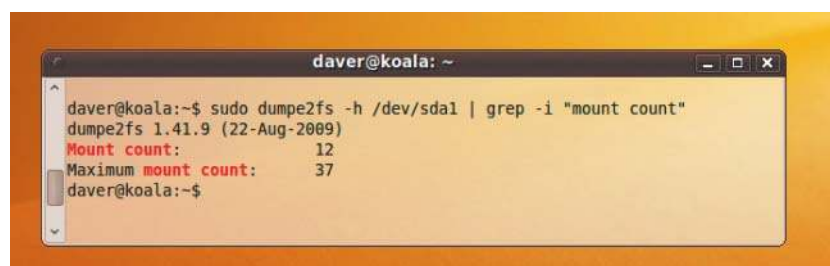
Angezählt: Das Dateisystem Ext2/3/4 merkt sich, wie oft eine Partition gemountet wurde. Ist der „Mount Count“ erreicht, findet beim Systemstart eine Überprüfung statt
