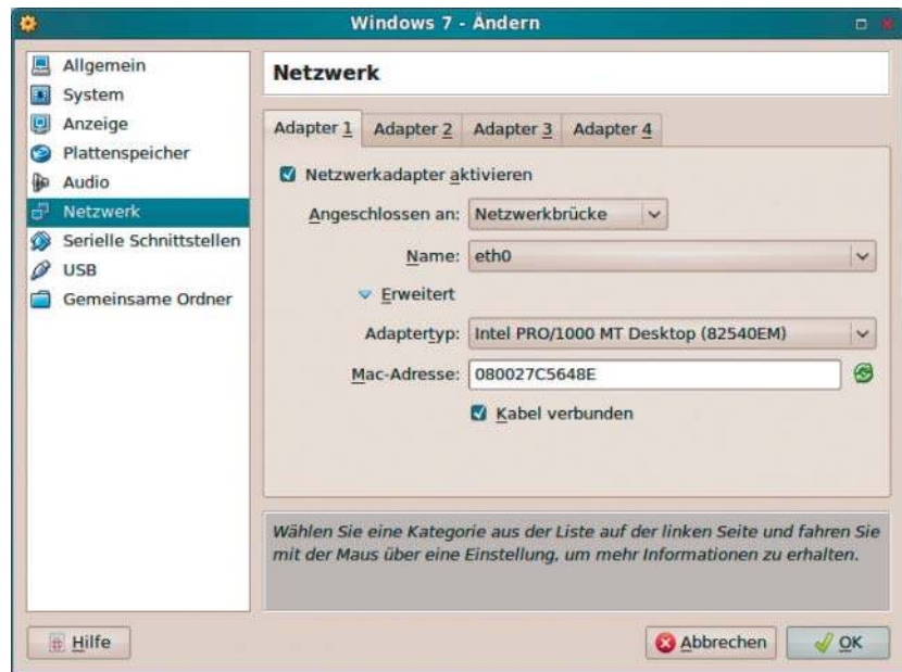
Netzwerkadapter der virtuellen Maschine konfigurieren: Wählen Sie „Netzwerkbrücke“ statt „NAT“ für die Schnittstelle eth0, dann können Sie auch auf Freigaben zugreifen
