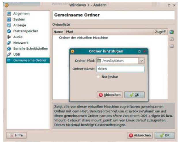
Daten tauschen zwischen Host und Gast: Bei ausgeschalteter Maschine ergänzen Sie gemeinsame Ordner in der Konfiguration
