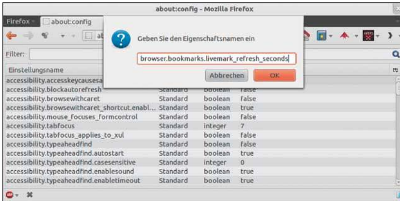
Immer aktuell: Mit diesem neuen Wert in der Konfiguration aktualisiert Firefox dynamische Lesezeichen, etwa RSS-Feeds, im gewünschten Zeitintervall.
