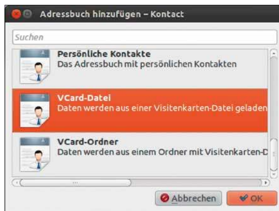
Adressbuch importieren: Exportieren Sie Ihre bestehenden Kontakte zunächst in eine VCard-Datei, dann klappt die Datenübernahme in Contact reibungslos.
