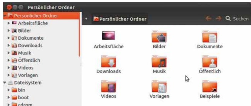
Home, sweet home: Jeder System-Benutzer erhält ein Home-Verzeichnis, in dem er seine eigenen Dateien und Konfigurationen unterbringen kann.
