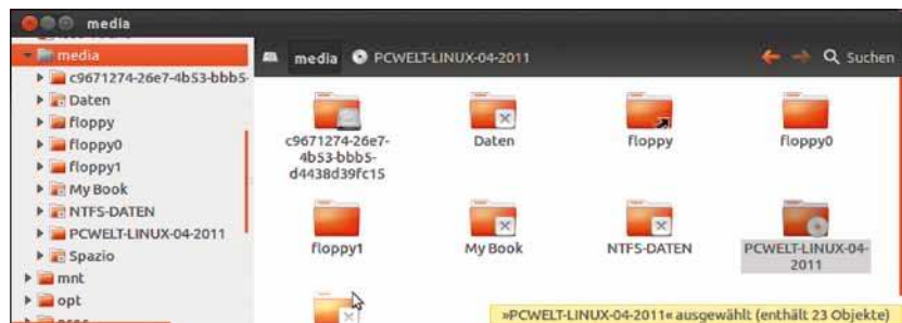
Zugriff auf externe Datenträger: Ins /media-Verzeichnis bindet Ubuntu zum Beispiel eingelegte DVDs, USB-Sticks oder externe Festplatten ein.
