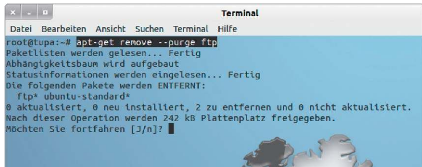
Überflüssiges einfach deinstallieren: Wenn Sie den FTP-Dienst nicht brauchen, können Sie ihn samt seiner Konfiguration entfernen, so dass der zugehörige Port verschlossen bleibt.
