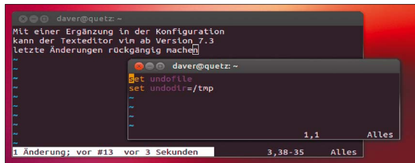
Rückwärtsgang einlegen: Mit dieser Ergänzung der Konfiguration kann der Texteditor vim (ab Version 7.3) letzte Änderungen an einer Datei mit dem Befehl :u rückgängig machen.
