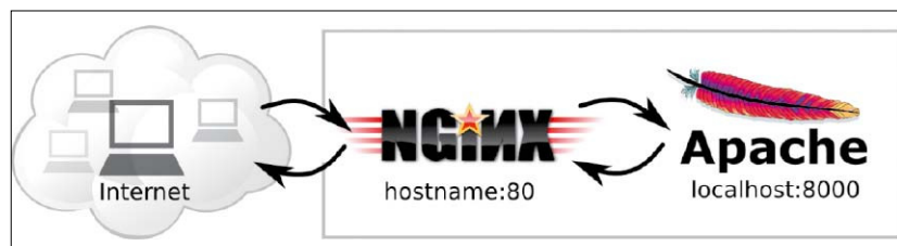
Türsteher: Ein vorgeschalteter Nginx als Reverse Proxy nimmt den Besucheransturm entgegen und kommuniziert intern mit dem Apache, auf dem die eigentlichen Inhalte liegen.
