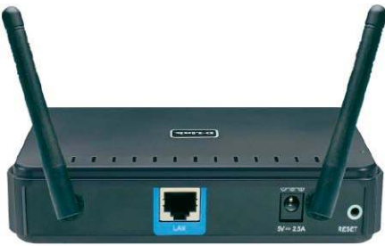
WLAN-Access-Point am LAN: Können Sie zur Funknetzerweiterung diese Option wählen, sollten Sie diese dem Einsatz eines Repeaters vorziehen.
