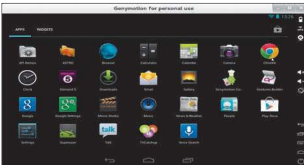
Android im Fenster: Genymotion nutzt installiertes Virtualbox, um X86-Images von Android in einer virtuellen Umgebung zu starten.
