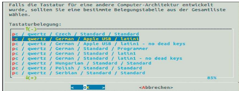
Deutsche Tastaturbelegung: In der Chroot-Umgebung konfigurieren Sie die deutsche Tastatur. Dann stehen beim ersten Start die richtigen Tasten zur Verfügung.
