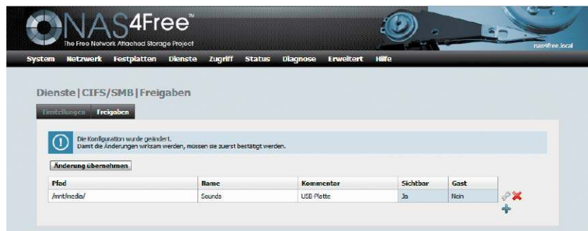
CIFS/SMB für Windows und Linux: Über „Dienste → CIFS/SMB → Freigaben“ definieren Sie die Netzwerkfreigaben. Diese Freigaben sehen Linux-, Windows und Apple-Rechner.
