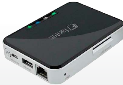
Mehr Speicher für Android: Die WLAN-Docking-Station von Fantec stellt den Inhalt von USB-Sticks, USB-Festplatten oder SD-Karten per WLAN bereit. Der Zugriff erfolgt über eine App oder über Samba.
