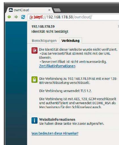
Problem mit HTTPS in Chrome: Der Google-Browser akzeptiert das mit Open SSL erzeugte Zertifikat nicht und lässt keine Verbindung zu. Firefox ist an dieser Stelle großzügiger.
