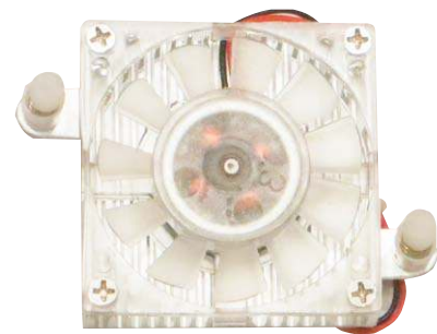
Odroid U3: Für den Dauerbetrieb sollten Sie den passiven Lüfter des Odroid gegen ein aktives Modell tauschen.
