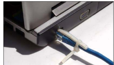
Stabiler Sitz: Die Kunststoffzunge des längs angebrachten Kabelbinders schiebt sich wie eine Haltetasche in die obere Ausbuchtung des Ethernet-Ports und verhindert damit ein leichtes Abziehen.
