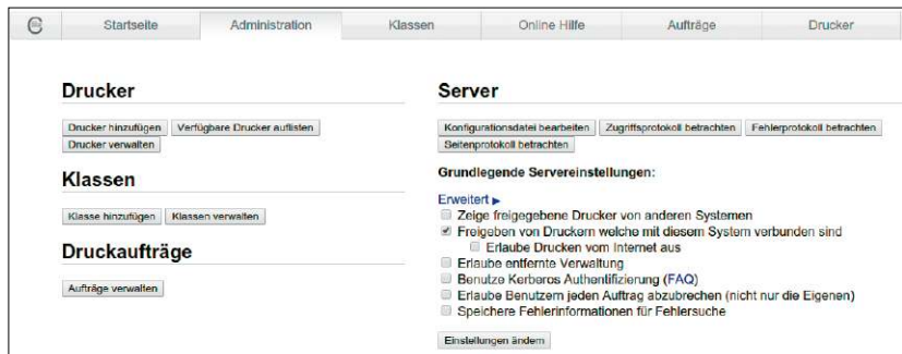
Cups-Verwaltungsoberfläche: Unter Ubuntu genügt es, im Common Unix Printing System die Druckerfreigabe zu aktivieren. Danach funktioniert auch Airprint.
