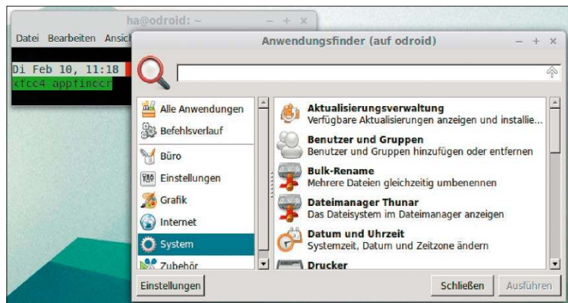
Grafische Programme per X11-Forwarding: Der „Anwendungsfinder“ läuft auf dem entfernten Server. Linux-Clients stellen den zweiten X-Server nach „ssh -X ...“ bereit, Windows und Mac-OS X brauchen dafür Extra-Software.
