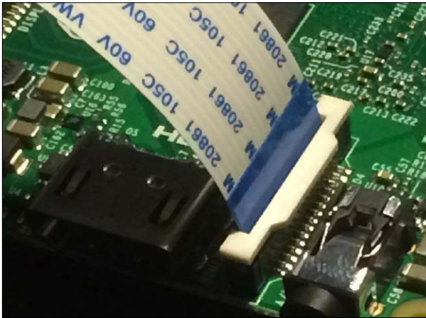
Auf dem Board des Raspberry Pi 2 ist der Anschluss für die Kamera vorbildlich beschriftet und liegt neben der HDMI-Buchse.
