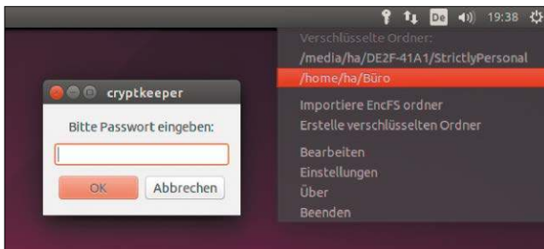
Grafische Mausbedienung für Encrypted File System: Cryptkeeper erscheint als Schlüsselssymbol in der Hauptleiste und bietet alle wesentlichen Enc-FS-Funktionen.
