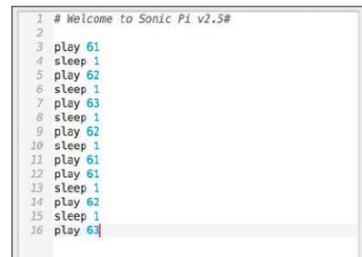
Durch die Anweisung „Sleep“ trennen Sie die Wiedergabe der Töne durch kurze Pausen. Nur so kommt Ordnung in das Klangergebnis.
