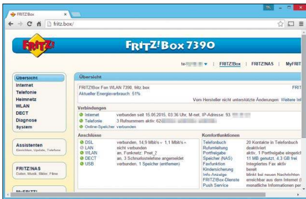
DSL-Router: Wenn die Konfigurationsseite des Routers im Browser erscheint, ist die Netzwerkverbindung in Ordnung. Sie sehen hier auch, ob eine Internetverbindung besteht.
