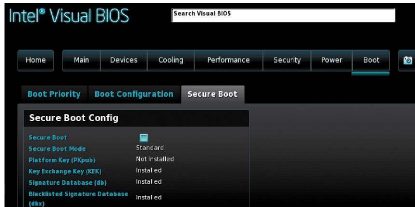
Einstellungen im Bios: Bei neueren PCs kann Secure Boot den Linux-Start verhindern. Deaktivieren Sie diese Option im Firmware-Setup.
