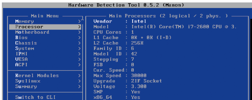
Bootfähiges HDT-Tool auf Heft-DVD: Das Werkzeug zeigt alle Hardware-Komponenten eines Rechners, unter anderem auch detailliert die Prozessoreigenschaften.
