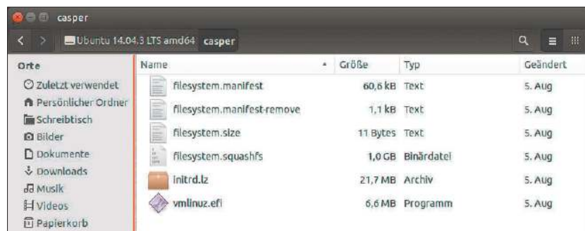
Ubuntu-Live-CD: Die Datei „filesystem.squashfs“ beherbergt im ISO-Abbild das komprimierte und schreibgeschützte Dateisystem des Linux-Systems.
