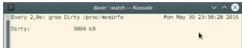
Wie lange dauert's noch? Bei Dateiübertragungen auf USB-Sticks zeigen Dateimanager den Fortschritt nicht an. Hier hilft der Blick in die Speicherverwaltung unter „/proc/meminfo“.
