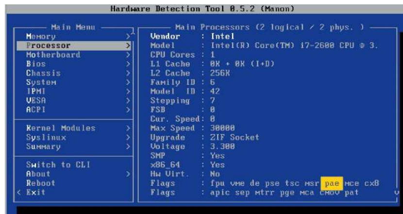
Bootfähiges HDT-Tool auf Heft-DVD: Das Werkzeug zeigt alle Hardwarekomponenten eines Rechners, unter anderem auch detailliert die Prozessoreigenschaften.
