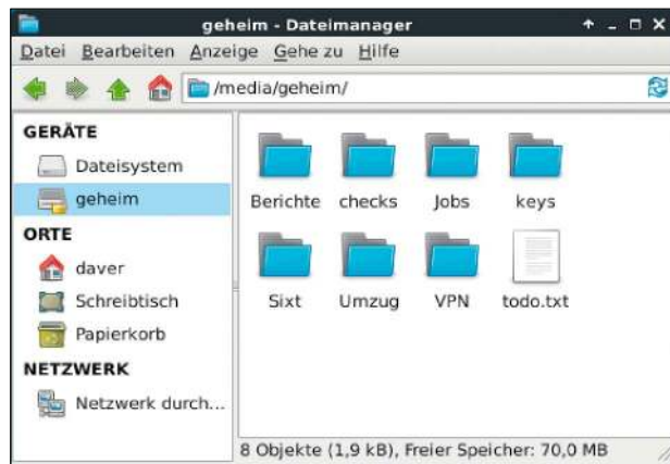
Geöffnetes Tomb: Eingehängte Containerdateien tauchen in Dateimanager wie externe Datenträger auf. Die Befehle chown und chmod setzen die gewünschten Zugriffsrechte.
