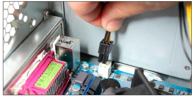
Einbau eines neuen Netzteils: Es gibt unscheinbare Stromstecker wie hier für die CPU, ohne die im Falle des Falles gar nichts geht.
