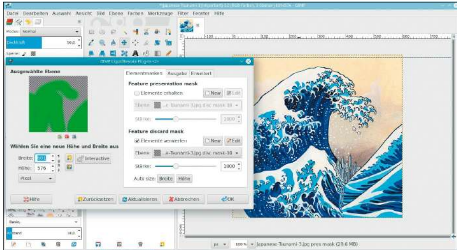
Liquid Rescale: Der Algorithmus zum Verkleinern von Bildern skaliert auf Wunsch nur unwichtige Bildbereiche. Dazu bietet das Gimp-Plug-in Ebenenmasken zum Markieren der Bereiche.
