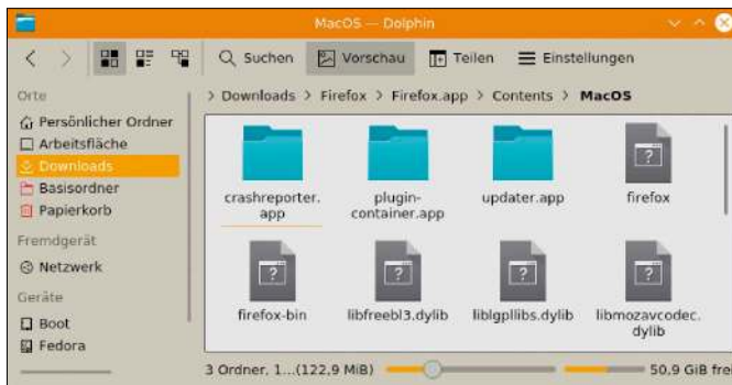
Blick in eine DMG-Datei: Die Archive von Mac-OS X können in unterschiedlichen Formaten vorliegen und sogar ganze Dateisysteme enthalten. Der Packer 7-Zip hilft meist weiter.
