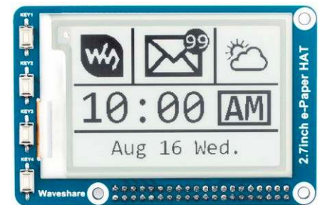
Stromsparende Anzeige: Ein E-Paper-Hat wird direkt auf die GPIO-Pins des Raspberry Pi gesteckt. Es eignet sich für die Anzeige von Benachrichtigungen oder Messwerten.
