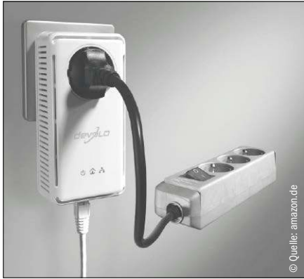
Power-LAN-Stecker: Die Netzwerkdaten laufen über die Stromleitung, die Restwege via Ethernet-Kabel zum Endgerät und Router. Die Weiterleitungssteckdose ist praktisch, wenn Wandsteckdosen knapp sind.
