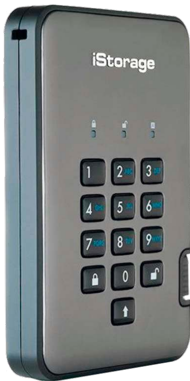
Mehr Sicherheit: Damit Ihre Daten nicht in falsche Hände geraten, sollten Sie externe Festplatten verschlüsseln. Die Diskashur 2 wird durch Eingabe einer PIN entsperrt.
