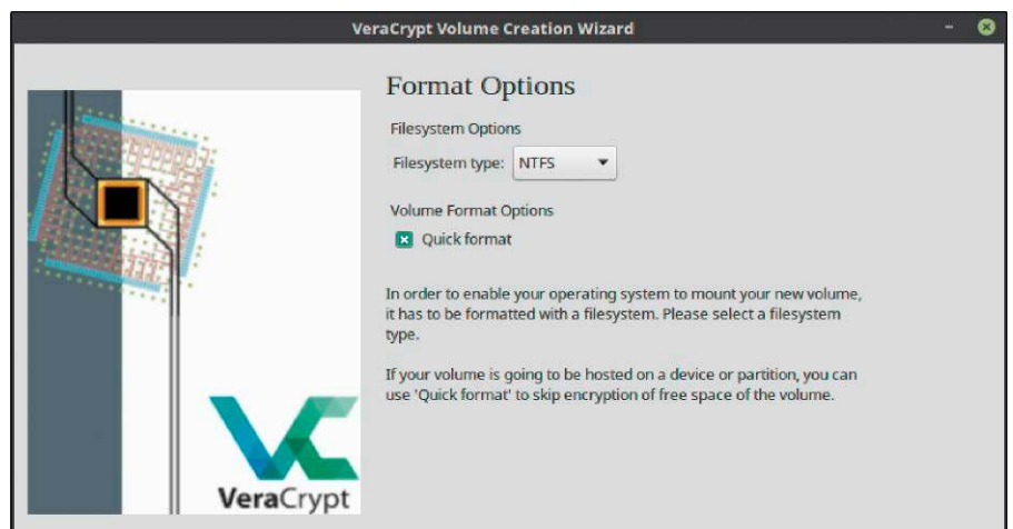
Dateisysteme: Sollen Veracrypt-Daten unter Linux wie Windows funktionieren, ist ein kompatibles Dateisystem wichtig – einmal für den USB-Datenträger selbst, zum andern für den Container.
