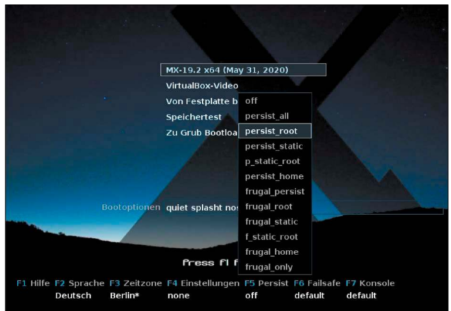
Einsatz als Livesystem: Im Livebetrieb bietet MX Linux diese Persistenzoptionen, um Systemänderungen zu speichern. Eine Kurzhilfe dazu finden Sie mit F1 unter „Hilfe“.
