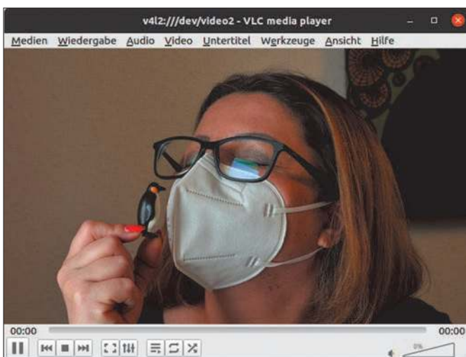
Tolles Bild dank DSLR statt Webcam: Mit Gphoto2 und dem Kernel-Modul von Video4Linux sind Spiegelreflexkameras als externe Webcams nutzbar (hier der Stream im VLC-Player).
