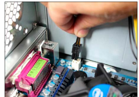
Vor dem Wechsel eines neuen Netzteils alles notieren! Es gibt unscheinbare zwei- und vierpolige Stromstecker wie hier für die CPU, ohne die im Falle des Falles gar nichts geht.
