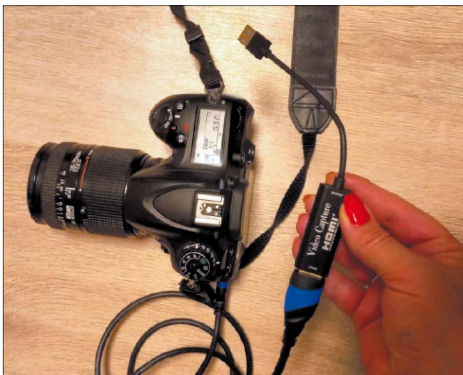
Per HDMI anzapfen: Eine DSLR von Nikon wird mit einem HDMI-Capture-Stick für weniger als 20 Euro zur hochauflösenden Webcam. Linux erkennt die Kamera als normale USB-Webcam.
