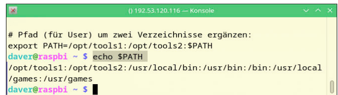
Erweiterte Pfade: Die Eingabe echo $PATH zeigt die Pfadvariablen an, die hier mit zwei Verzeichnissen unterhalb von ./opt über die Datei ~/.profile ergänzt wurde.
