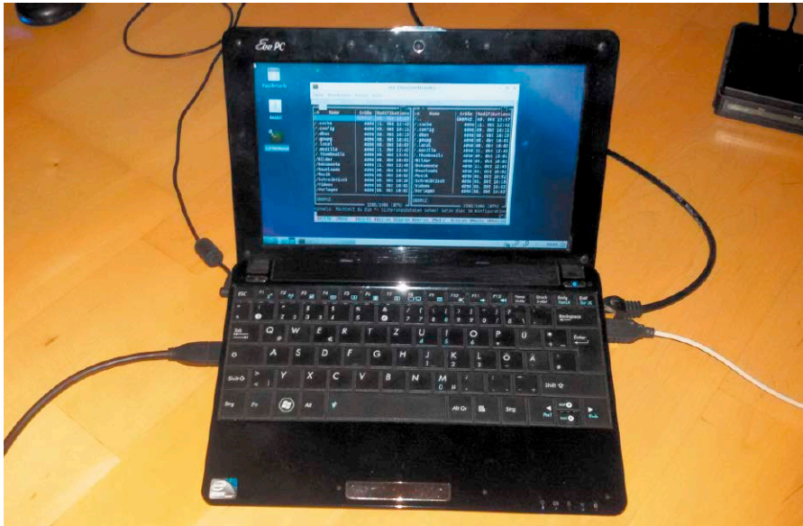
Altes Netbook als Datenserver: Das ist mindestens Homeoffice-tauglich, wenngleich Geschwindigkeitsrekorde mit Fast Ethernet und USB 2.0 nicht zu erwarten sind.
