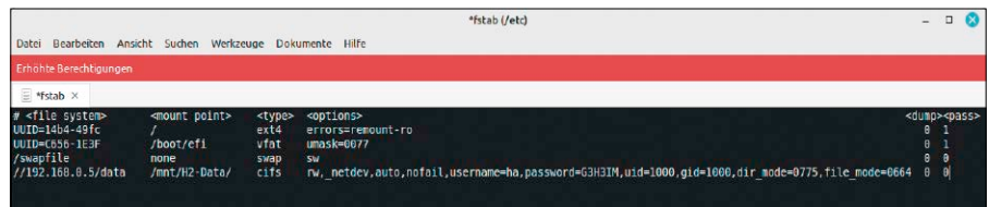
Freigaben automatisch mounten: Mit einer Anweisung in der Datei „/etc/fstab“ lässt sich eine Samba/Windows-Freigabe ab Systemstart in das Dateisystem einhängen.
