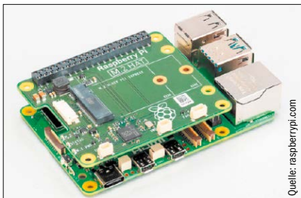
Dieser Raspberry-Aufsatz (HAT) wird die kürzeren M.2-NVMe-Speicher mit 30 oder 42 Millimetern Länge aufnehmen. Für die gebräuchlicheren 80-mm-Karten gibt es ein zweites HAT.
